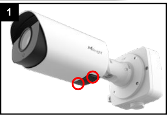
1 Schrauben an unterer schwarzer Abdeckung lösen.
