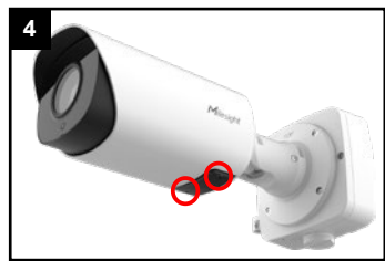
4 Abdeckung wieder festschrauben.
